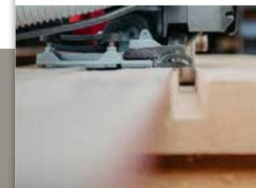
Благодаря регулируемому приспособлению для выборки пазов, поставляемому в качестве специальной принадлежности, можно эффективно и быстро выполнять пазы, например для установки кабелей питания.
